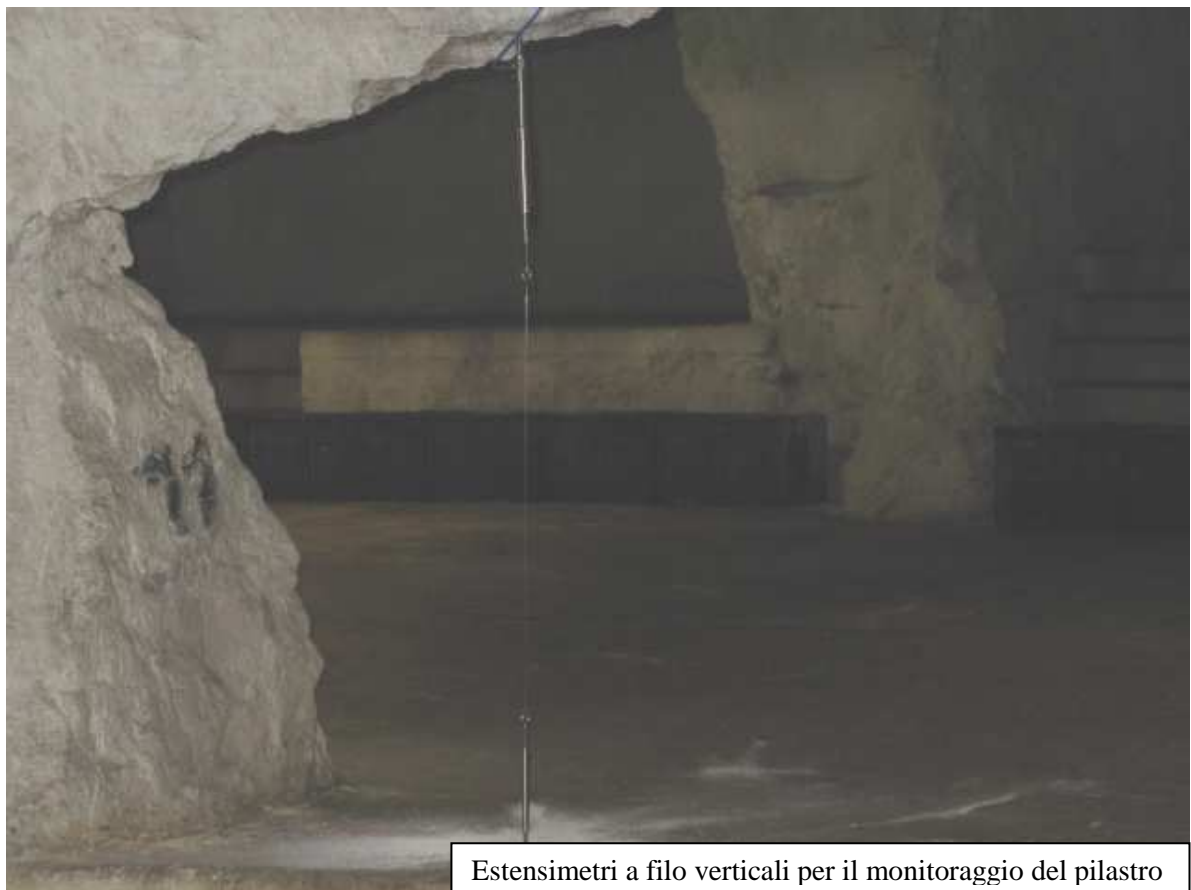
Estensimetri a filo verticali per il monitoraggio della volta
